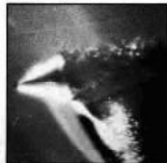
Abtaststift: metallgefärbter, ganzer Stein vorn an Nadelträger angeklebt; elliptisch
