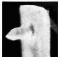
Abtaststift: ganzer, nackter Stein; hyperelliptisch; Nadelträger: Alu-Röhrchen, abgeplattet
