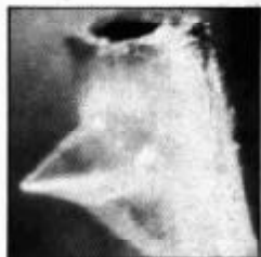
Abtaststift: ganzer, nackter Stein, geklebt; elliptisch; Nadelträger: Alu-Röhrchen, vorn abgeplattet
