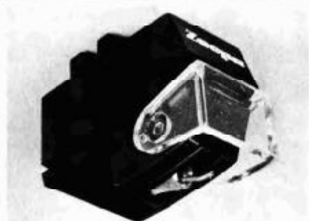
Zeepa Black Devil: dynamischer Tonabnehmer mit bewegter Spule, Auflagekraft 13 bis 20 mN, Übertragungsfaktor ohne Übertrager 0,056 mVs/cm, Übersprechdämpfung 35 dB bei 1 kHz, Kanalabweichung <2 dB, Nadelnachgiebigkeit 23 mm/N, Innenwiderstand 0,75 Ω, empfohlener Lastwiderstand 47 kΩ, vertikaler Spurwinkel 20°, Gewicht 5,5 g, Preis 480 DM Abstannadel des Zeepa Black Devil: kristallorientiertes, nacktes, elliptisch geschliffenes Stäbchen, „Fine Line“-Schliff, keine Angaben über Verrundungsradius
