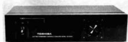
2 Entzerrer-Vorverstärker SZ-1000 für Toshiba-Tonabnehmer C-400. Technische Daten: Nenn-Eingangsspegel 30 mV, Eingangsimpedanz 33 k \Omega , Nenn-Ausgangsspegel 500 mV, empfohlener Lastwiderstand 30 k \Omega , Frequenzgang bei optimaler Anpassung 20 bis 50 000 Hz, Abmessungen 260 \times 60 \times 120 (B \times H \times T in mm)
